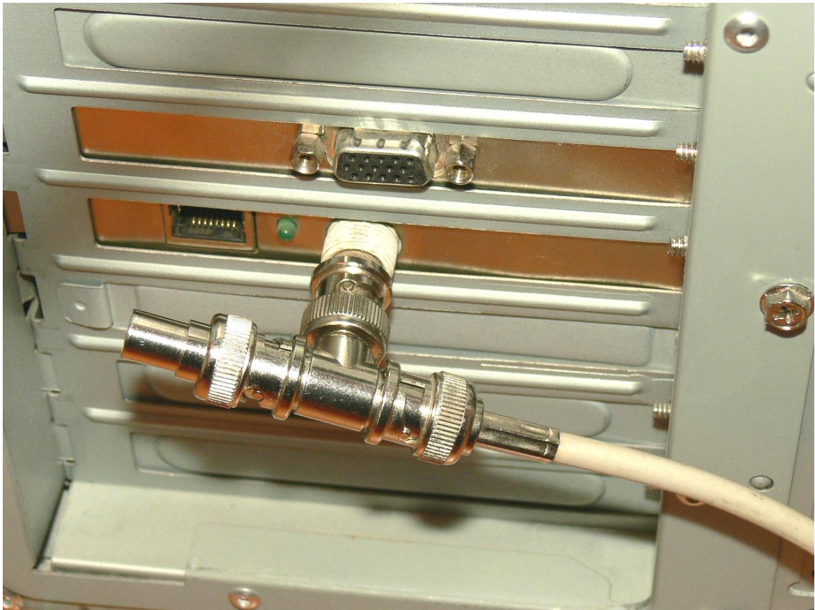
Рис. 3.1. Подключение коаксиального кабеля и терминатора к Т-коннектору, установленному на BNC-разъеме сетевого адаптера
